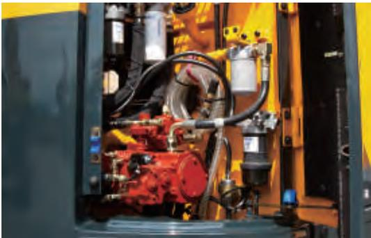
Per ottenere la massima precisione, Hyundai ha riprogettato l'impianto idraulico per offrire all'operatore la massima maneggevolezza e manovrabilità. Le valvole a bobina nella valvola di controllo sono progettate per fornire una portata più precisa a ciascuna funzione, con uno sforzo minore.
