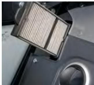
I filtri dell'aria sono facilmente accessibili per facilitare la manutenzione.
