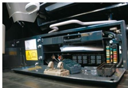
Le cinghie del ventilatore e dell'aria condizionata sono facilmente accessibili sotto uno sportello esterno sul lato destro della cabina. All'interno del cofano posteriore destro, la batteria è protetta con una lastra in metallo, i componenti elettrici si trovano sotto il sedile.
