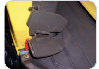
Pedali di comando circuito ausiliario e brandeggio dotati di robuste protezioni pieghevoli per evitare i rischi di movimenti imprevisti.
